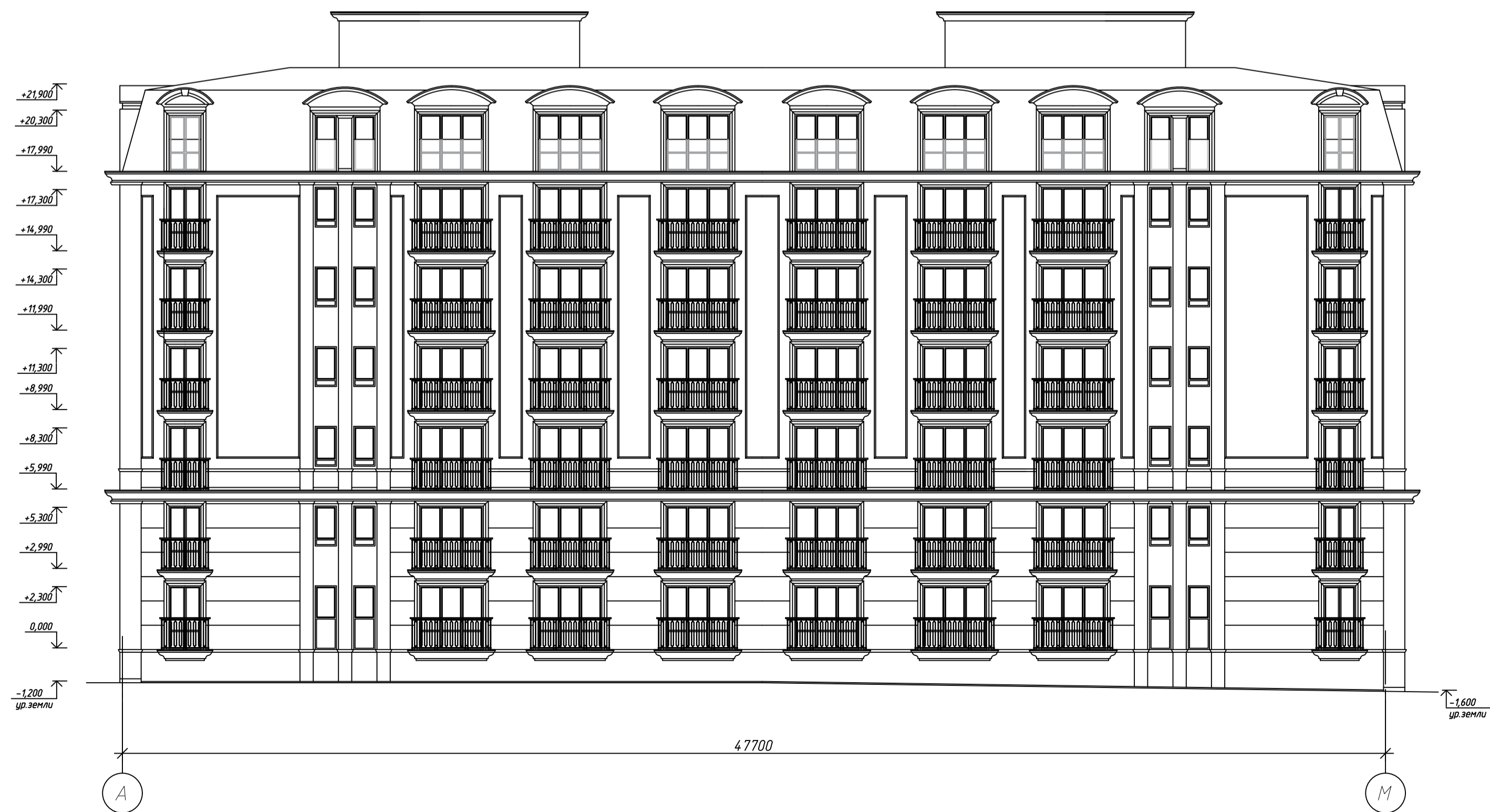
Фасад в осях Б-М. М1.150
